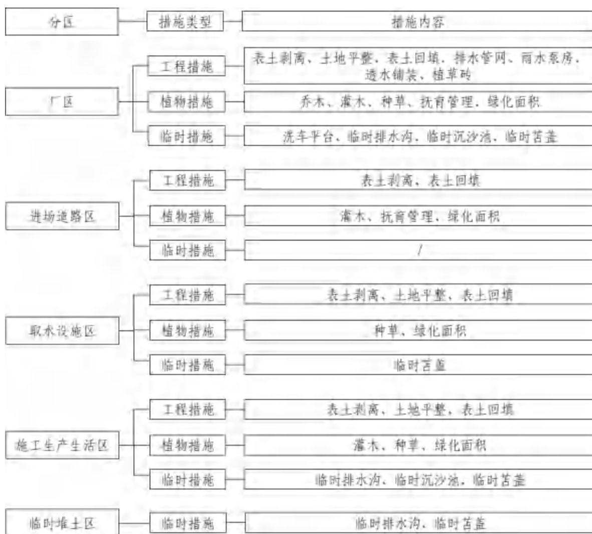
图 3-1 实际工程水土保持措施防护体系图
